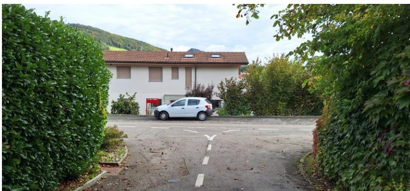
Abbildung 6: Nicht ausreichend Sichtweite z.B. Föhrenstrasse. (Quelle: Gemeinde Lostorf).
